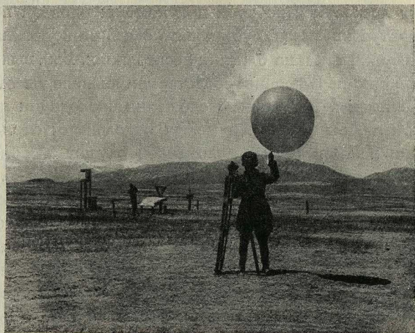
Пуск шара-пилота с Каракульской метеорологической станции.
