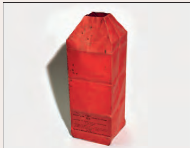
Рис. 10. Дорожный фонарь для темной комнаты фирмы «Бревете» (Париж); имеет 4 стенки из красного неактивного материала, освещается изнутри свечой или керосиновой лампой. Музей истории фотографии (Санкт-Петербург). Фото Д. С. Шнеерсона. С любезного разрешения музея
