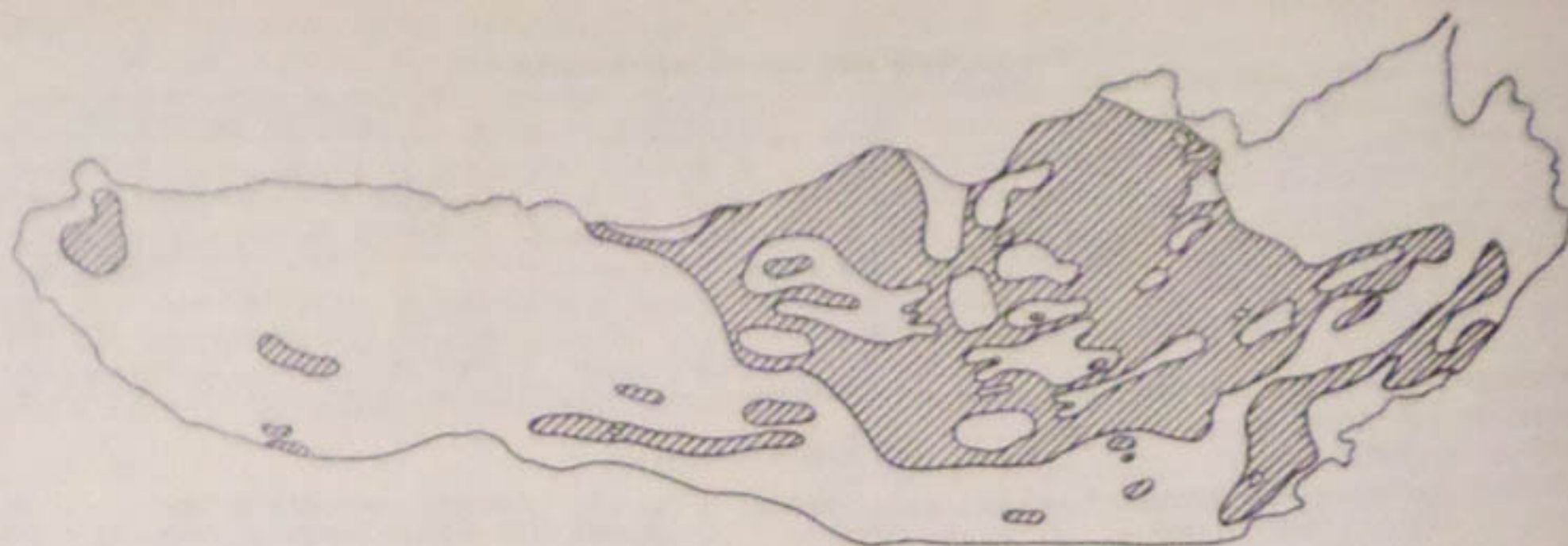
Рис. 9.3. Схема просядок грунта Кайраккумского водохранилища. Штриховкой выделена зона просядок.
