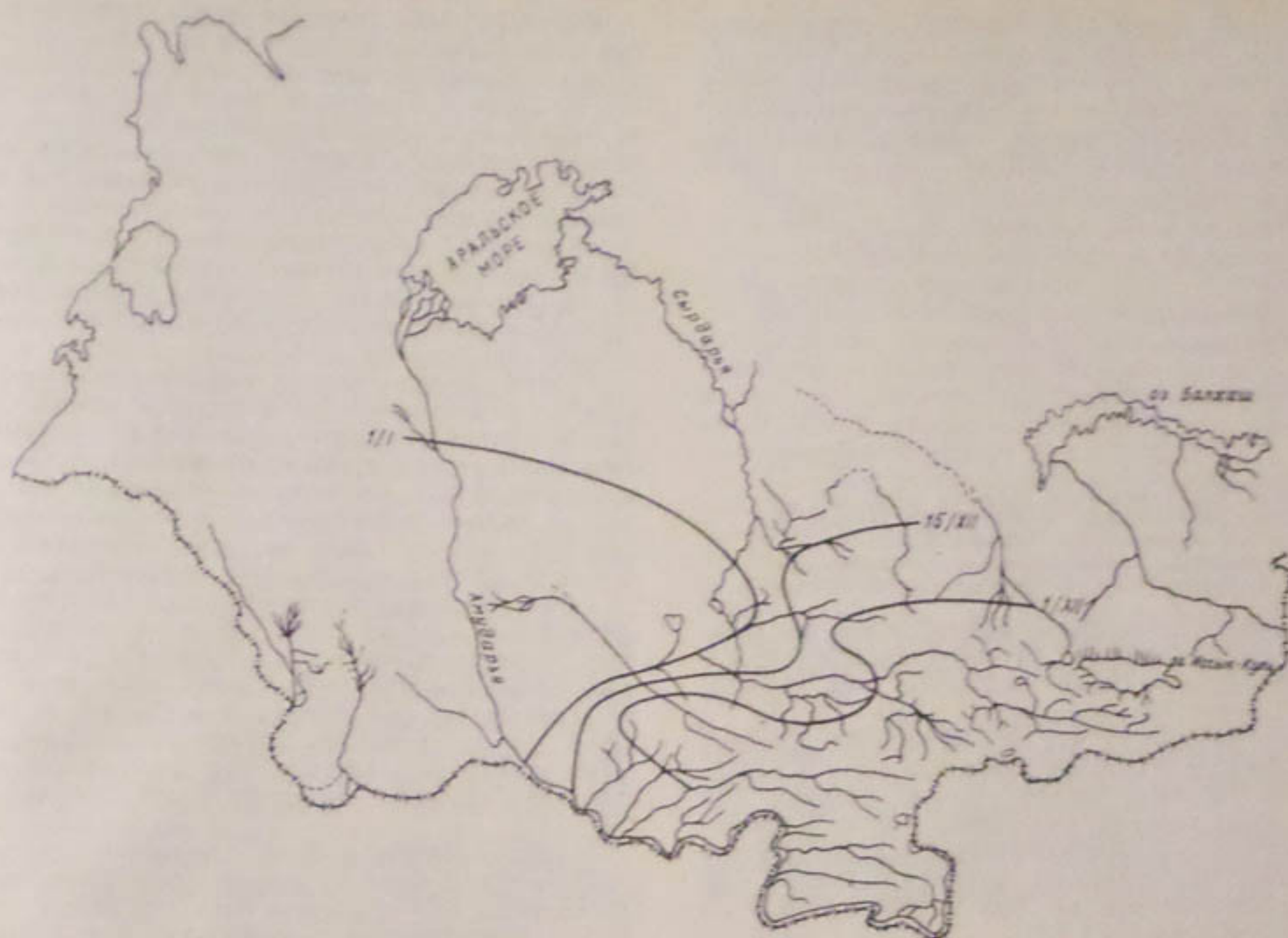
Рис. 6.6. Распределение средних дат начала осенних ледовых явлений на водохранилищах Средней Азии.
