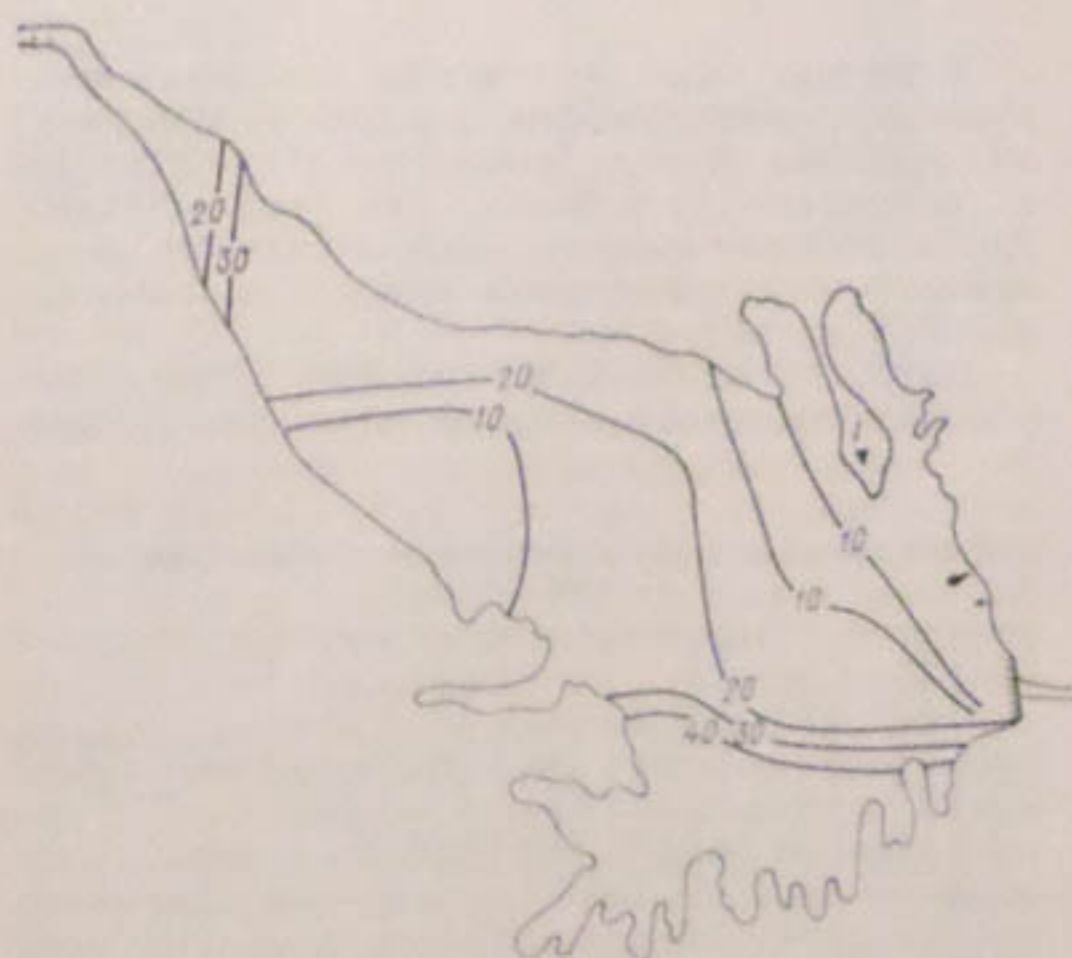
Рис. 9.4. Распределение мутности (г/м 3 ) по акватории Урта-токайского водохранилища. I — пост наблюдений Узгидромета.
