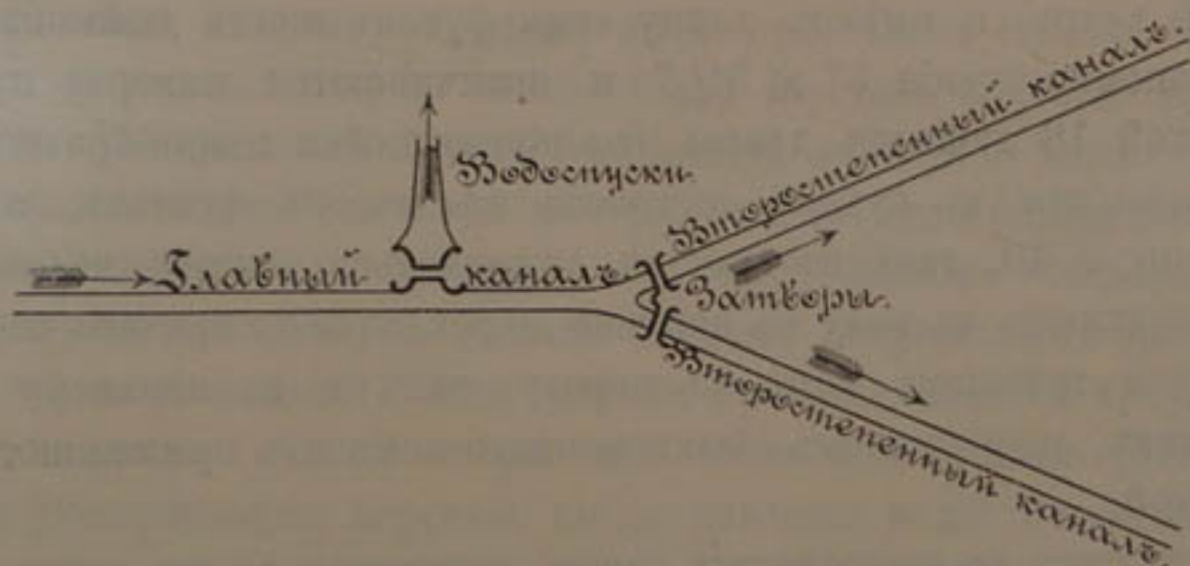
Черт. 136. — Схема расположенія затворовъ и водоспусковъ при началѣ второстепенныхъ каналовъ.
