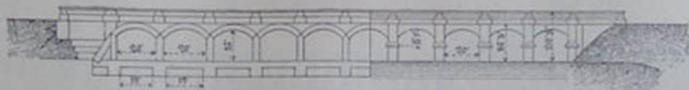
Черт. 27. — Продольное сѣченіе. Видъ снизу (по теченію). Общая ширина живого сѣченія 237' 1\frac{1}{2}'' . 10 отверстій, 20' каждое. 9 быковъ 4' 9\frac{1}{2}'' каждый.
