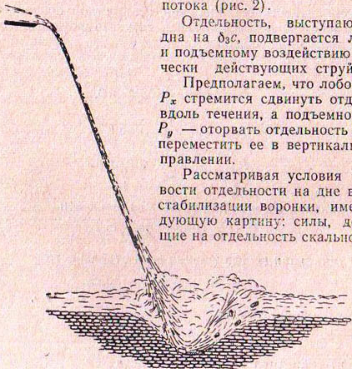
Рис. 2. Схема размыва скального основания падающей струей воды.
