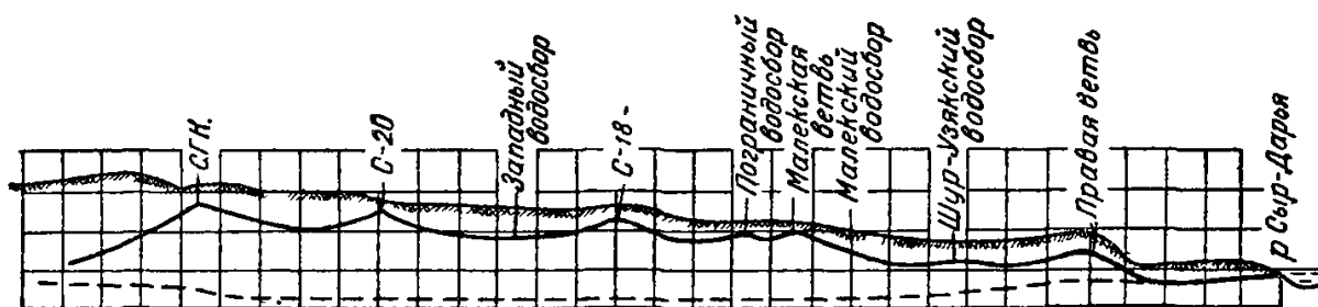
Рис. 44. Значение ирригационных каналов в подъеме уровня и питании грунтовых вод Голодной Степи (Крылов). Условные обозначения: — — — горизонт грунтовых вод до орошения (1908—1911 гг.); ————— горизонт грунтовых вод.
