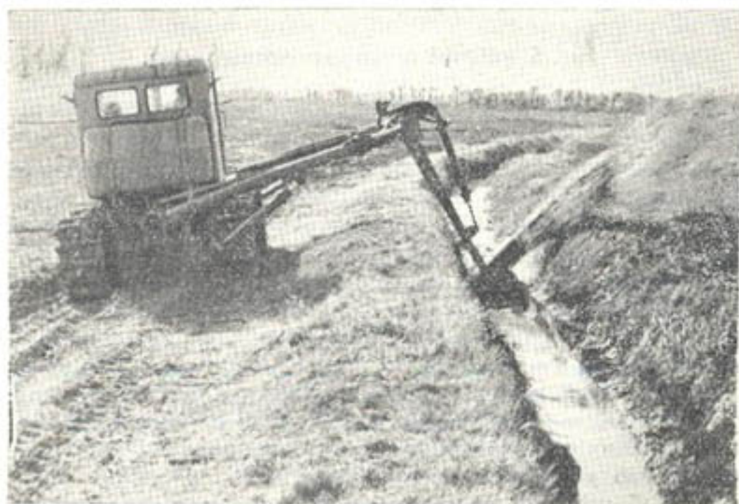
Рис. 4. Каналоочиститель Д-342А с роторным рабочим органом.
