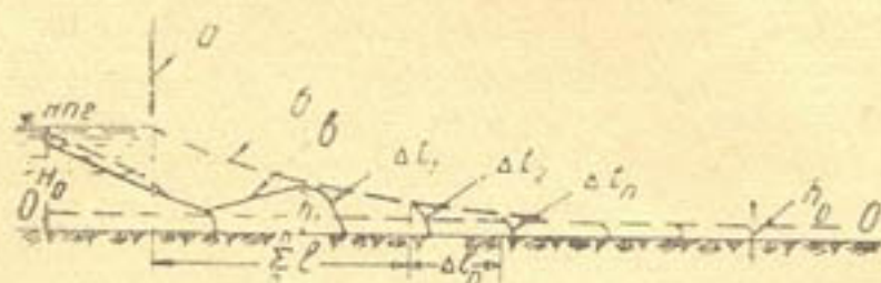
Рис. 1. Схема движения прорывной волны по сухому руслу:
