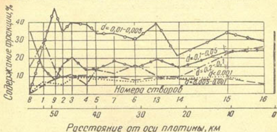
Рис. 5. График изменения фракционного состава донных отложений наносов по длине Кайраккумского водохранилища (13—23.IX 1959 г.).
