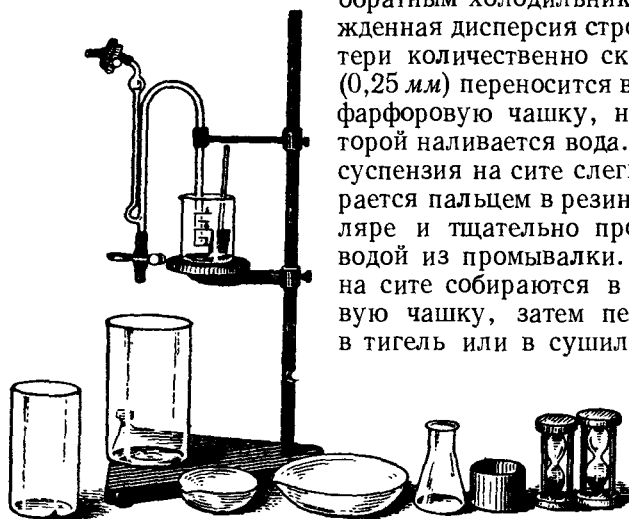
Рис. 13. Прибор Сабанина для механического анализа почвы
