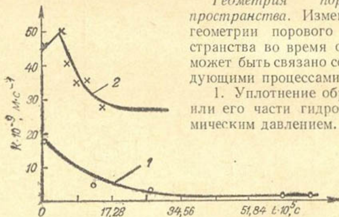
Рис. 16. Зависимость коэффициента фильтрации от времени:
