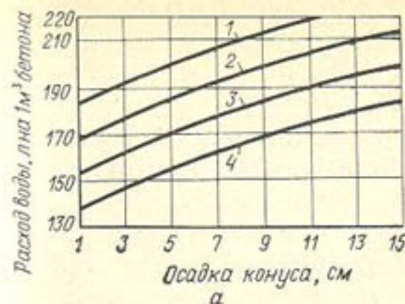
Рис. 5.4. Водопотребность пластичных (а) и жестких (б) бетонных смесей из портландцемента, песка средней крупности с водопоглощением 7% и гравия:
