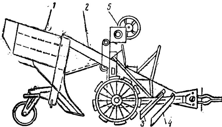
Рис. 68. Канавокопатель КМ-80У:
