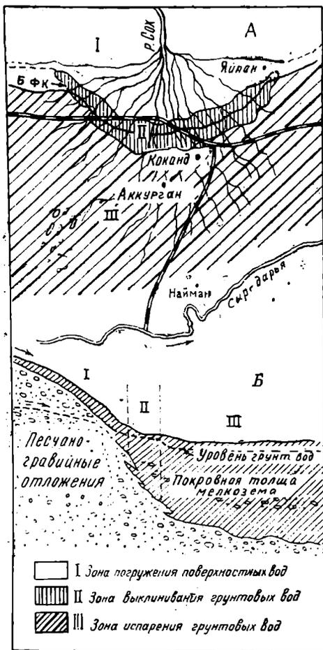
Рис. 4. Гидрогеологические зоны земель системы р. Сох (А — план; Б — в разрезе)
