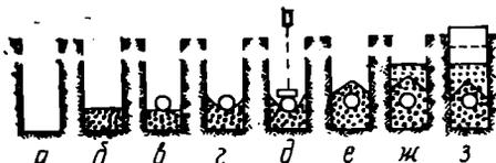
Рис. 78. Схема технологического процесса, выполняемого дреноукладчиком Д-251
