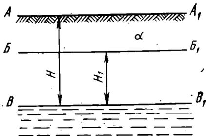
Рис. 27. Схема условий критического уровня минерализованных грунтовых вод (по Б. Б. Польшову):
