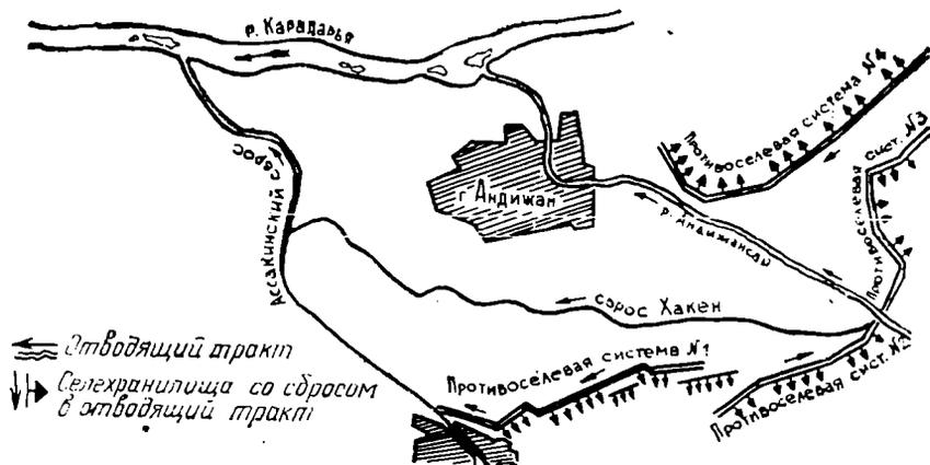
Рис. 103. Схема противоселевых сооружений у гор. Андижана
