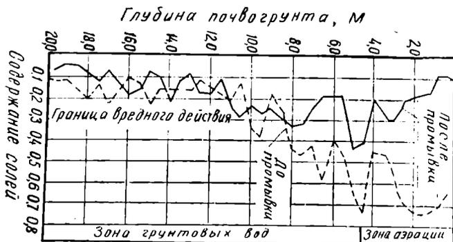
Рис. 92. Запас вредных солей в почвогрунте до и после промывки нормой 64 тыс. м<sup>3</sup>/га (ВНИИГиМ, 1963)
