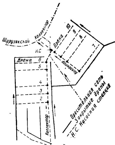
Рис. 88. Расположение оросительной и дренажной сети на Золотоординской опытно-мелиоративной станции (Голодная степь)
