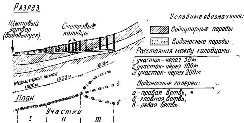
Рис. 35. Кяриз (схема устройства). По Б. Я. Стрелковскому
