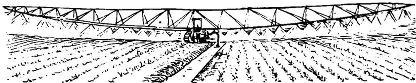
Рис. 49. Двухконсольный дождевательный аппарат ДДА-100М (расход воды 100 л/сек)
