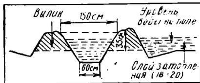
Рис. 55. Временный ороситель (ок-арык), устроенный палодателем за два параллельных прохода
