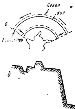
Рис. 100. Защита головы оврага: а — план; б — разрез
