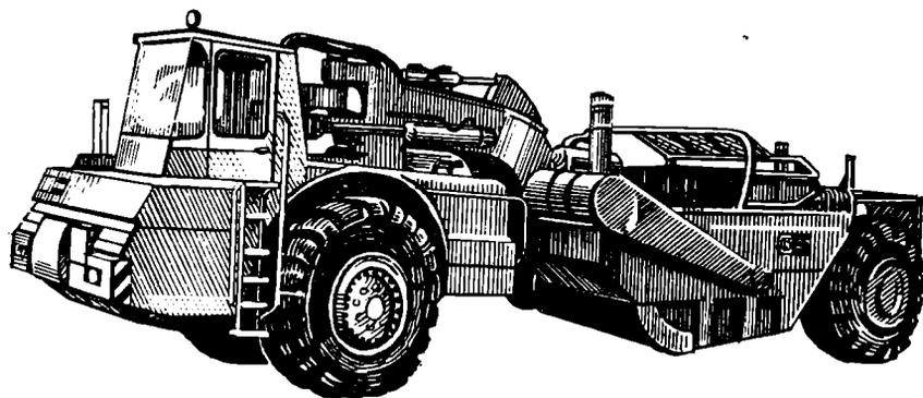
Рис. 41. Скрепер Д-354 (емкость ковша 2,75 м<sup>3</sup>)
