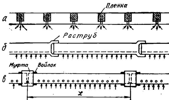
Рис. 72. Стыки дренажных труб и поступление воды в трубы:
