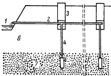
Рис. 75. Закрытая дрена со скважинами-усилителями:
