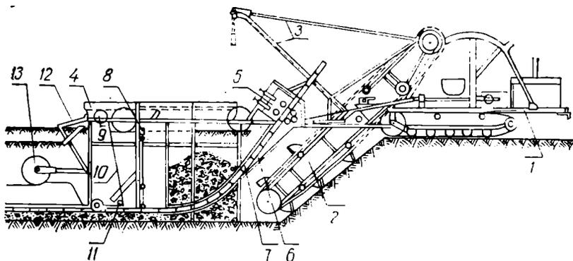
Рис. 76. Схема дренаукладчика:
