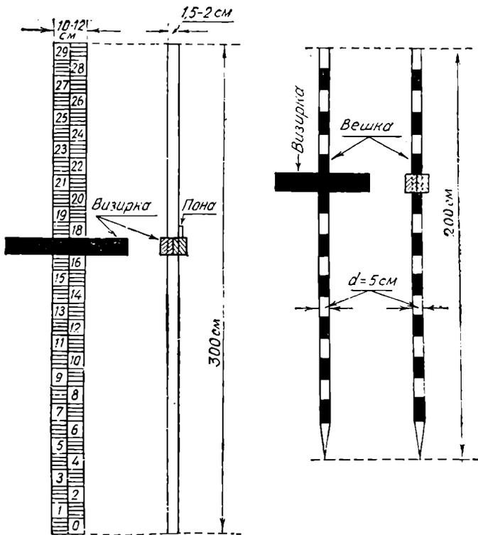
Рис. 39. Визирки для высотных отметок при планировочных работах
