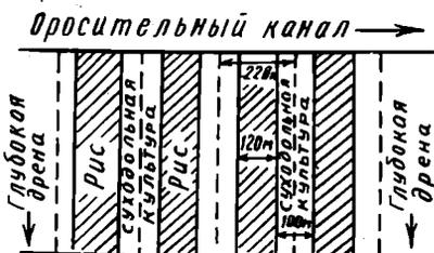
Рис. 91. Схема расположения посевов при двухтактной форсированной промывке
