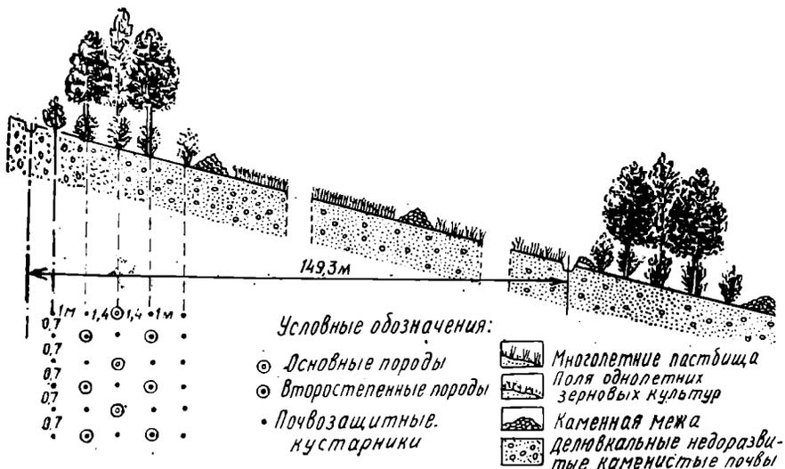
Рис. 96. Схема размещения лесных полос и водозадерживающих канав при севообороте с многолетними травами на богарных почвах при склоне  $15^\circ$  (по ВНИАЛМИ)
