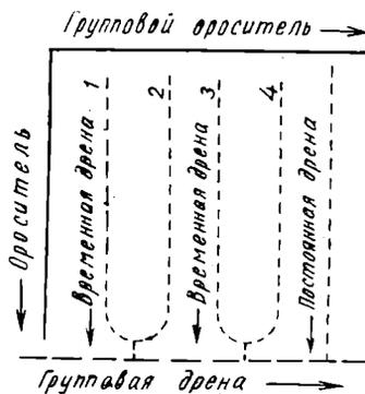
Рис. 69. Расположение временных мелких и постоянных глубоких дрен
