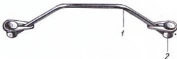
Рис. 2.3. Сифон пластмассовый: 1 — колено; 2 — стакан
