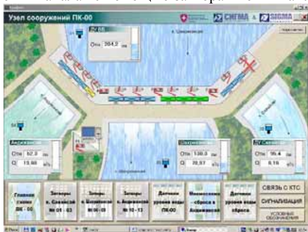
Рис. 7. Кампирраватский гидроузел главная мнемосхема системы SCADA
