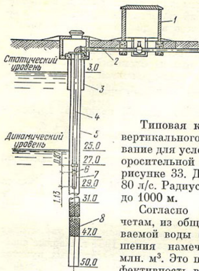
Рис. 33. Типовая конструкция скважины вертикального дренажа:
