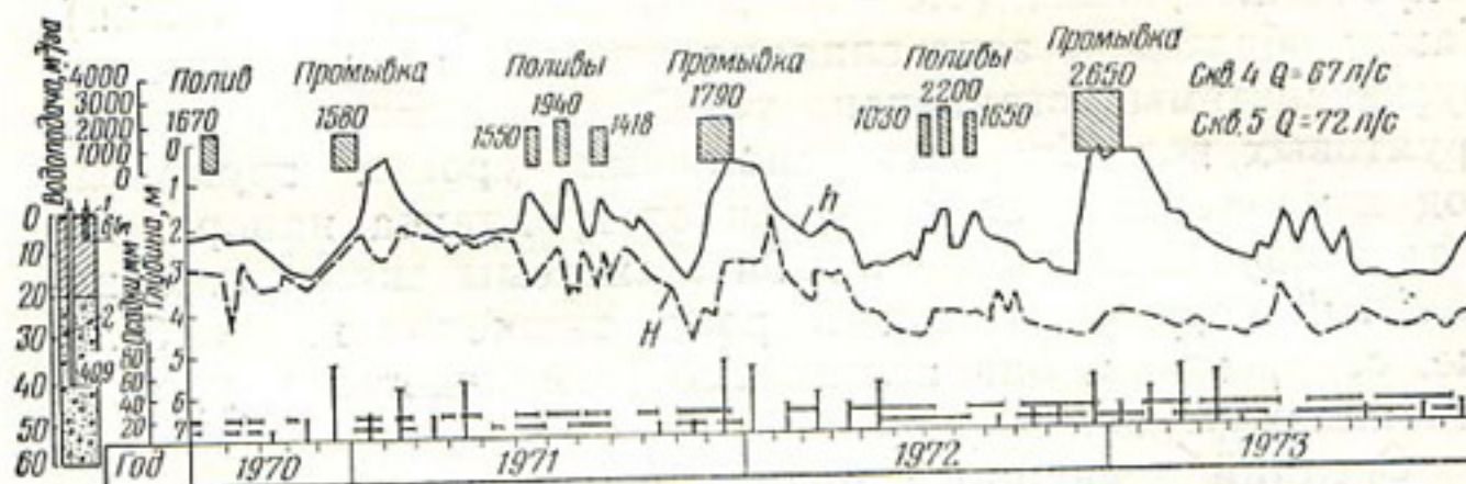
Рис. 23. График режима грунтовых и напорных вод на орошаемом поле, куст № 60 (хлопчатник), на фоне вертикального дренажа. Совхоз «Социализм», Шурузякский массив:
