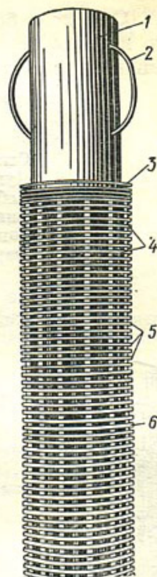
Рис. 45. Конструкция каркасно-стержневого фильтра (Дрогобычский завод):
