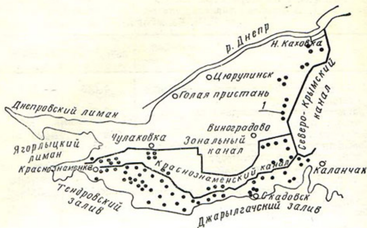
Рис. 31. Схема вертикального дренажа на Краснознаменской оросительной системе (по данным Укргипроводхоза):
