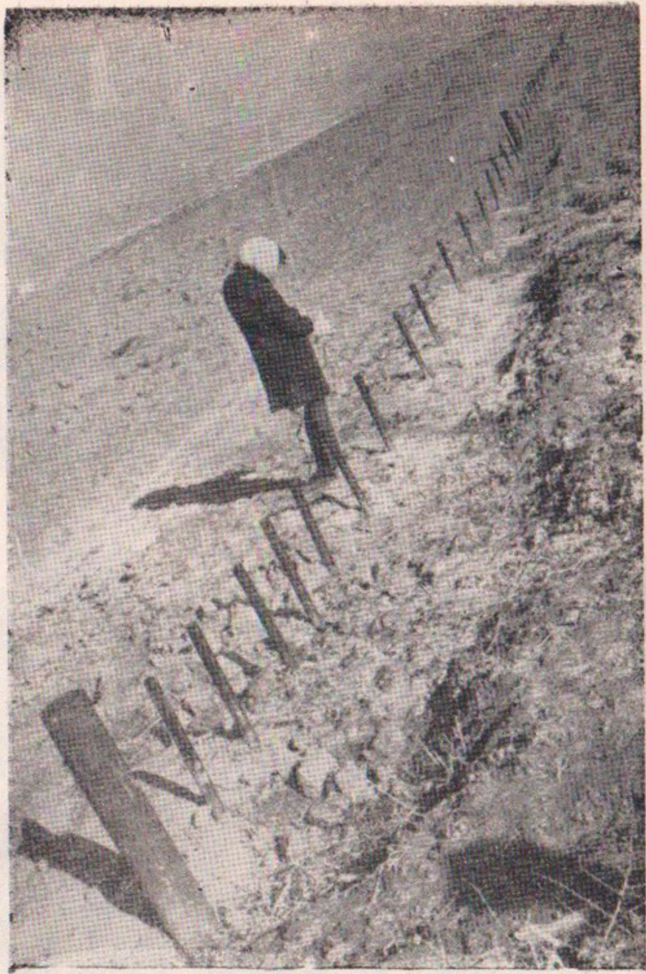
Рис. 11. Створ наблюдательных скважин и пьезометров.
