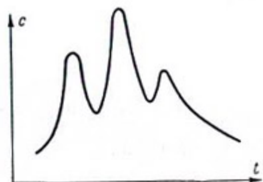
Рис. 4-9. Кривая хода индикатора при исследованиях в многослойном пласте.
