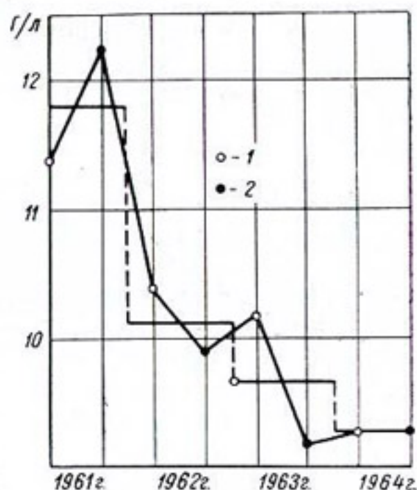
Рис. 8-18. График сезонных изменений осредненных значений минерализации по пробам воды из пьезометров нижне-соликамского горизонта в цементационной потерне.
