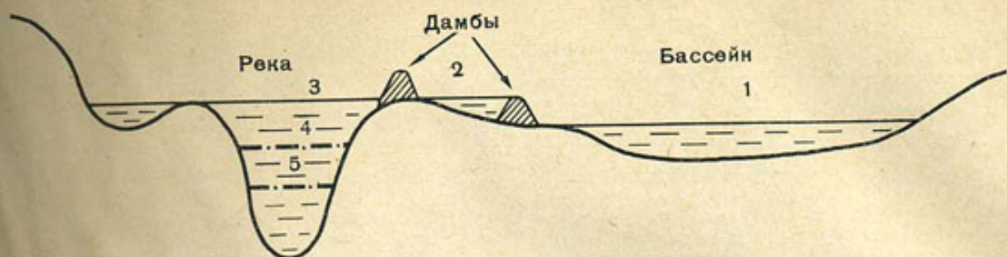
Рис. 24. Простейшая бассейновая оросительная система: 1 — бассейн; 2 — дамбы; 3 — высший уровень паводкового разлива реки; 4 — средний; 5 — низший
