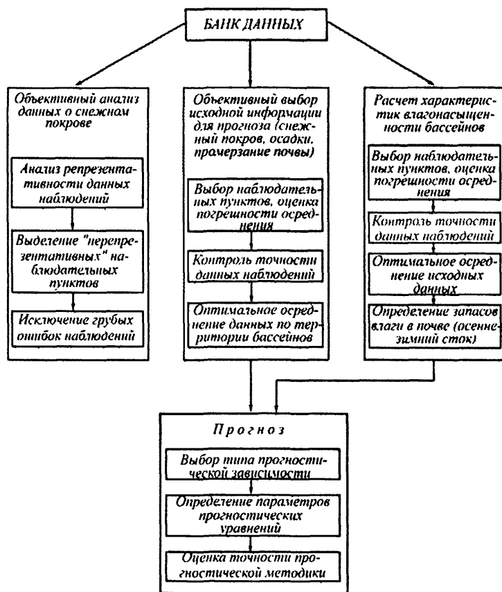
Рис. 7.20. Блок-схема разработки методики прогнозов весеннего стока с помощью ЭВМ.
