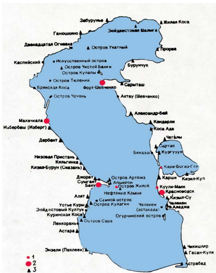
Рис. 3.1. Схема расположения уровенных постов на Каспийском море [6]: действующие (1), вековые (2), закрытые (3).
