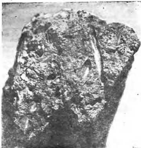
Рис. 46. Куя-Ургенч. Структура известково-зольного раствора с добавкой самана, укреплявшего мраморное кольцо на основании минарета 1011 г.
