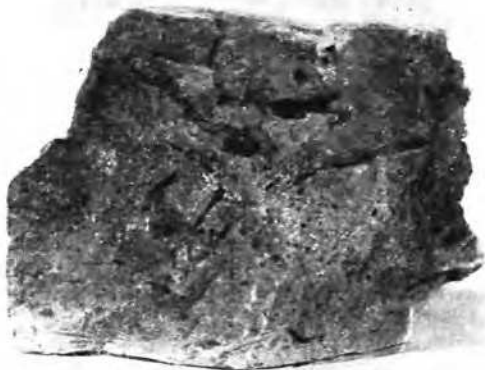
Рис. 8. Древний Мерв. Структура кирпича I—II вв. н. э. В изломе видны следы самана и крупных стеблей, выгоревших при обжиге.
