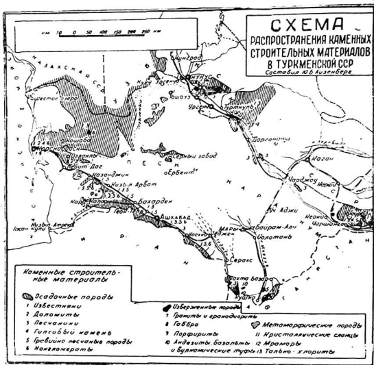
Рис. 2. Схема распространения каменных строительных материалов в Туркменской ССР.
