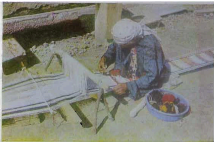
Ормек — ткацкий станок. На фото — ткање на станке «диабе» тесьмы для связывания жердей кровли юрты. Хлопчатобумажная основа, орнаменты из шерстяных ниток (Тахтакупырский район, 1965 г.).
