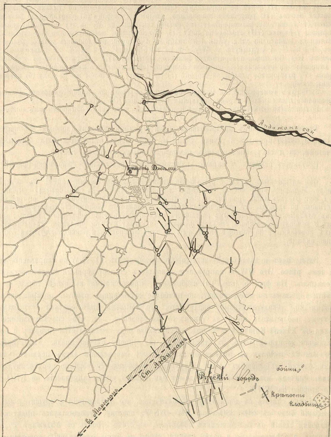
Фиг. 6. Направленiя сотрясенiй въ туземномъ городѣ, опредѣленные по типичнымъ разрушенiямъ.
