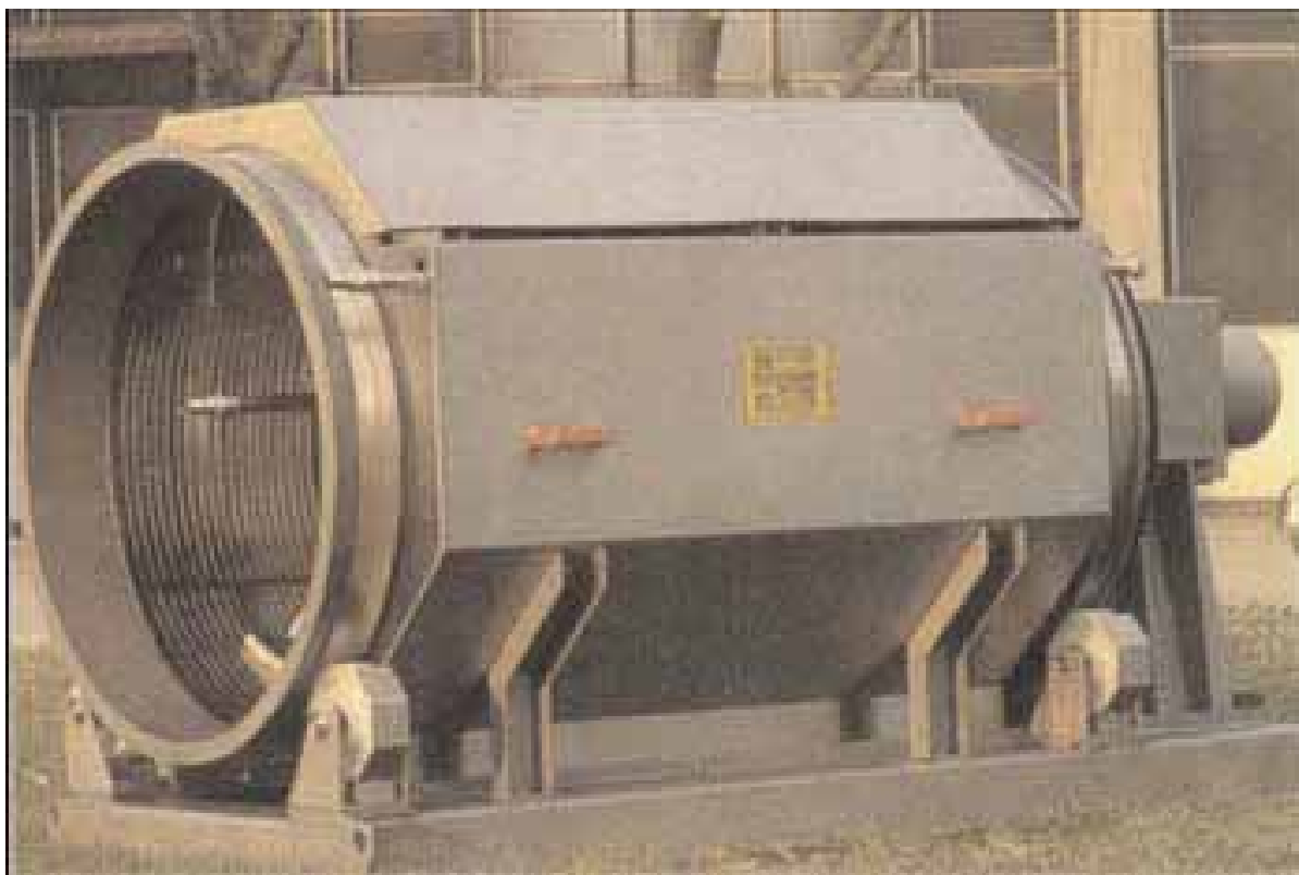
Рисунок 4. Сито с цилиндрической вращающейся решеткой для сепарации твердых фекальных частиц
