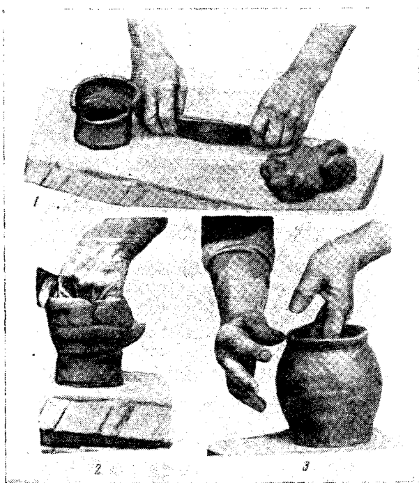
Рис. 6. Основные этапы формовки кольцевым налепом: 1, 2 — соединение колец; 3 — заглаживание после соединения колец
