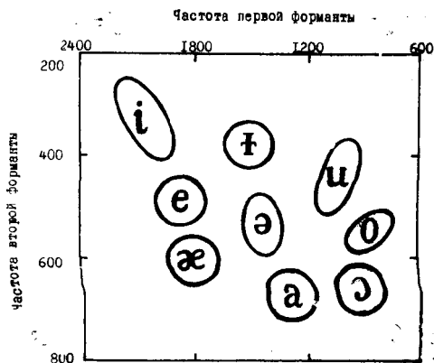
Рис. 4. "Треугольник" основных английских гласных, построенный на основе спектральных данных с учетом двух первых формант ( F_1 и F_2 )
