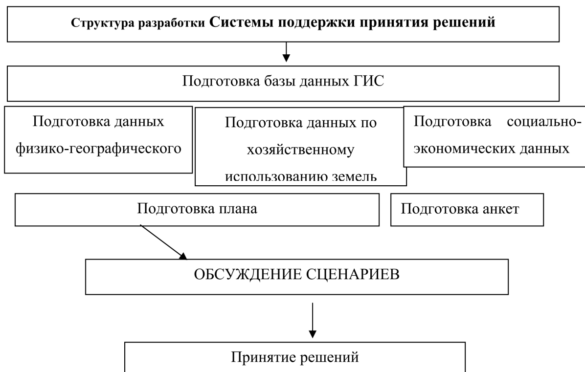
Рис. 9. Общая структура Системы поддержки принятия решений
