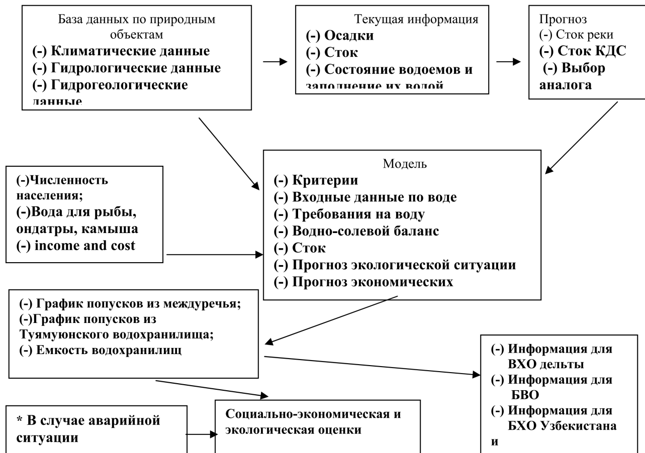
Рис 5. Схема СППР (DSS) проекта SFP NATO 974357 [9].
