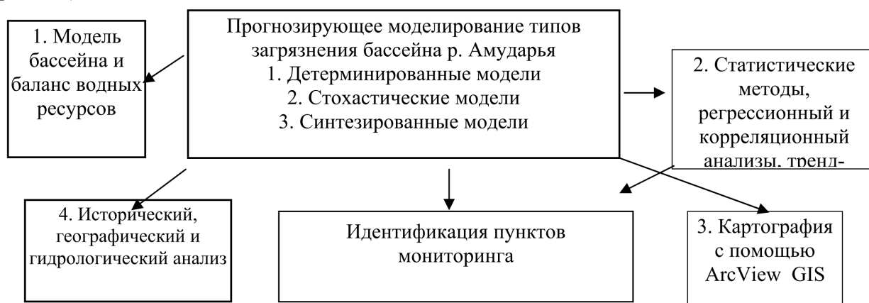
Рис.6. Входящие и выходящие компоненты модели бассейна реки Амударья
