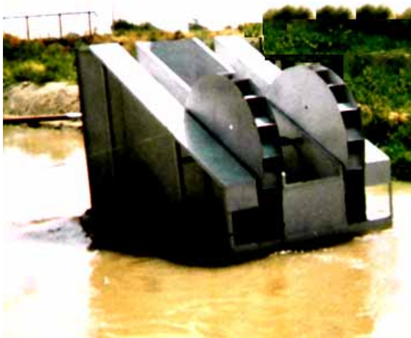
Рис. 2. Натурный образец микроГЭС во время испытания
