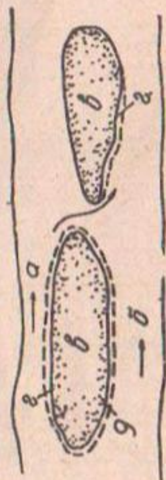
Рис. 6. Схема дендрита IV типа. а - фарватер \frac{1}{2} расхода; б - фарватер \frac{2}{3} расхода; в - ветрива \frac{1}{2} расхода; г - зона отложения.
