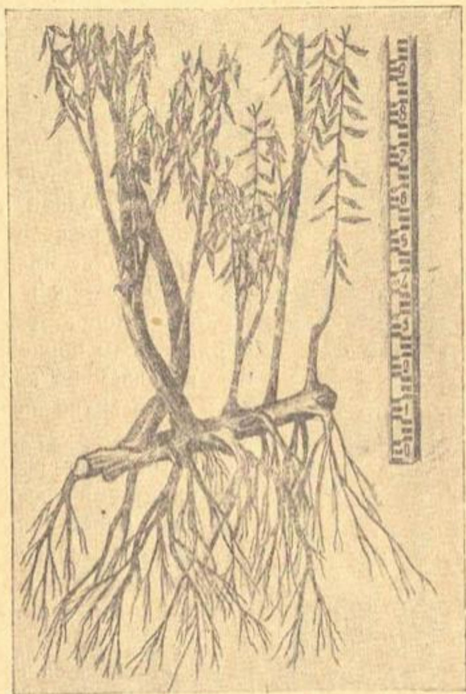
Рис. 3. Развитие корневой системы и надземной поросли на части живого ивового хлыста (1,0 м) в борозде откоса (через 6 месяцев после укладки хлыста в крепление)
