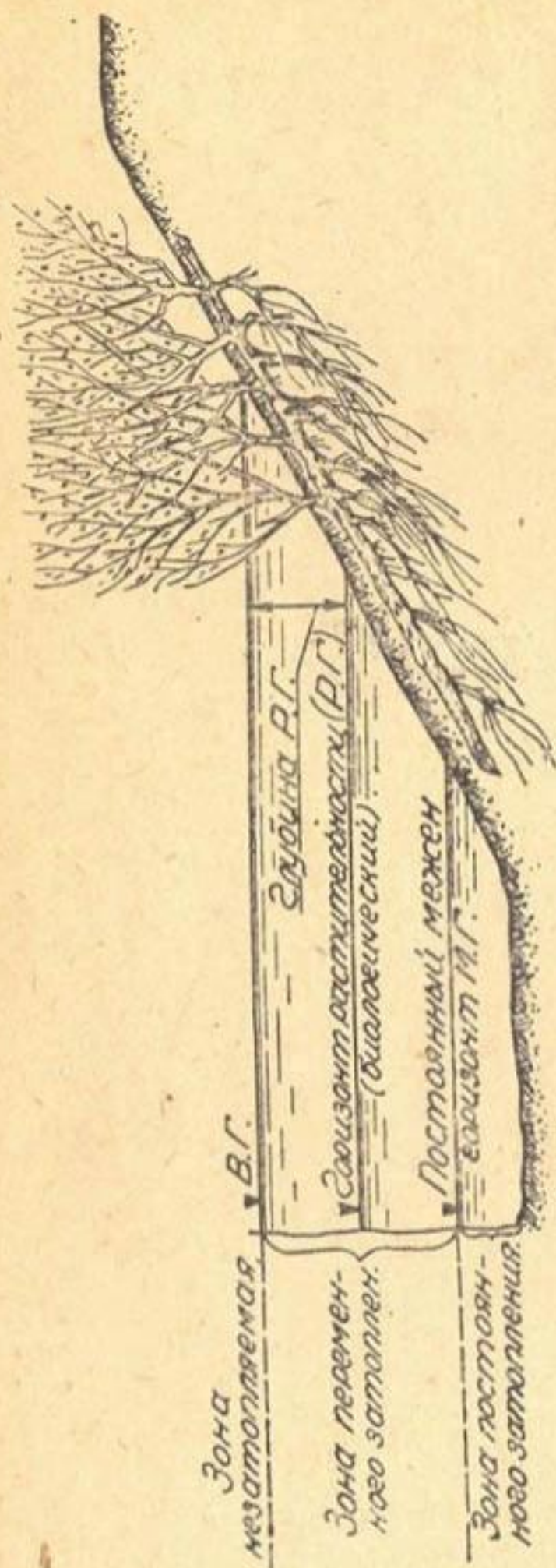
Рис. 4. Положение расчетных горизонтов и схема развития корневой системы и надземной поросли в креплении откоса
