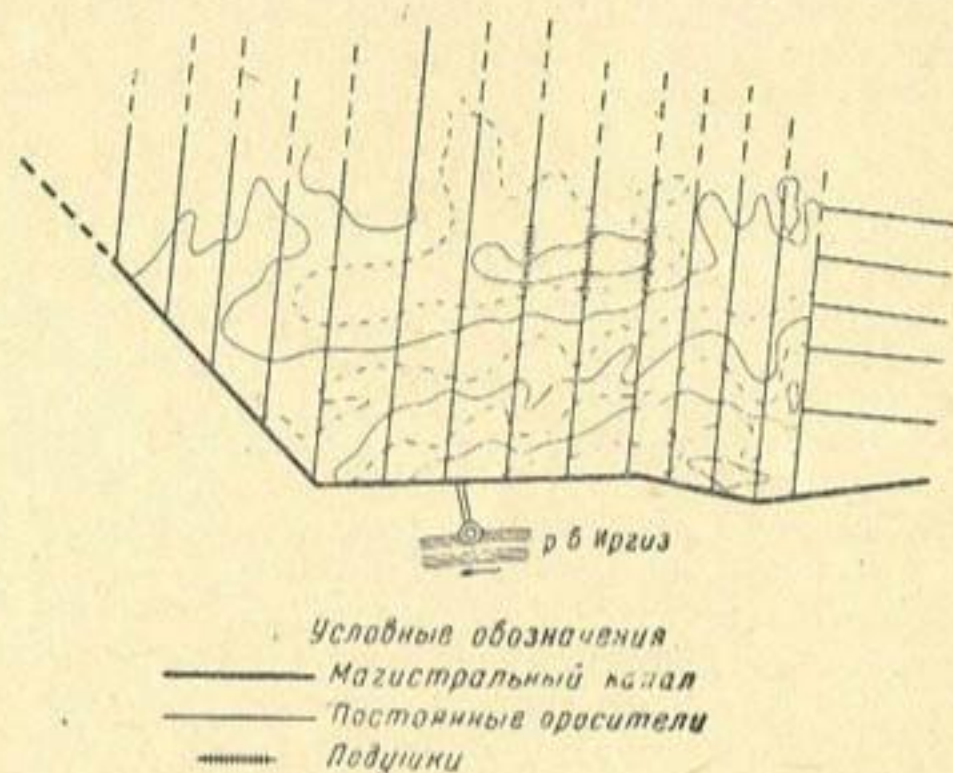
Рис. 23. План орошаемого участка колхоза имени Кирова с постоянной сетью.
