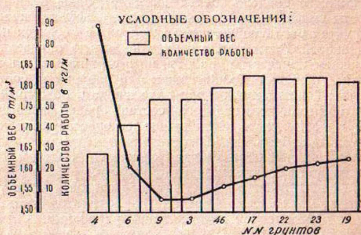
Р и с. 9. Предельная плотность грунтов различного солевого состава и количество работы, потребное для достижения \sigma = 1,6 \text{ т/м}^3 при влажности, равной максимальной молекулярной влагоемкости.
