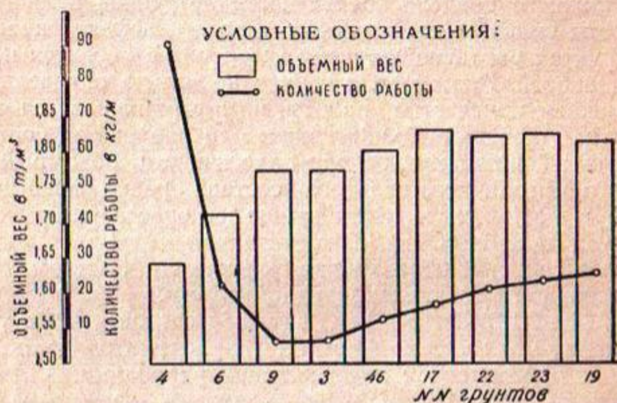
Р и с. 9. Предельная плотность грунтов различного солевого состава и количество работы, потребное для достижения \sigma = 1,6 т/м^3 при влажности, равной максимальной молекулярной влагоемкости.
