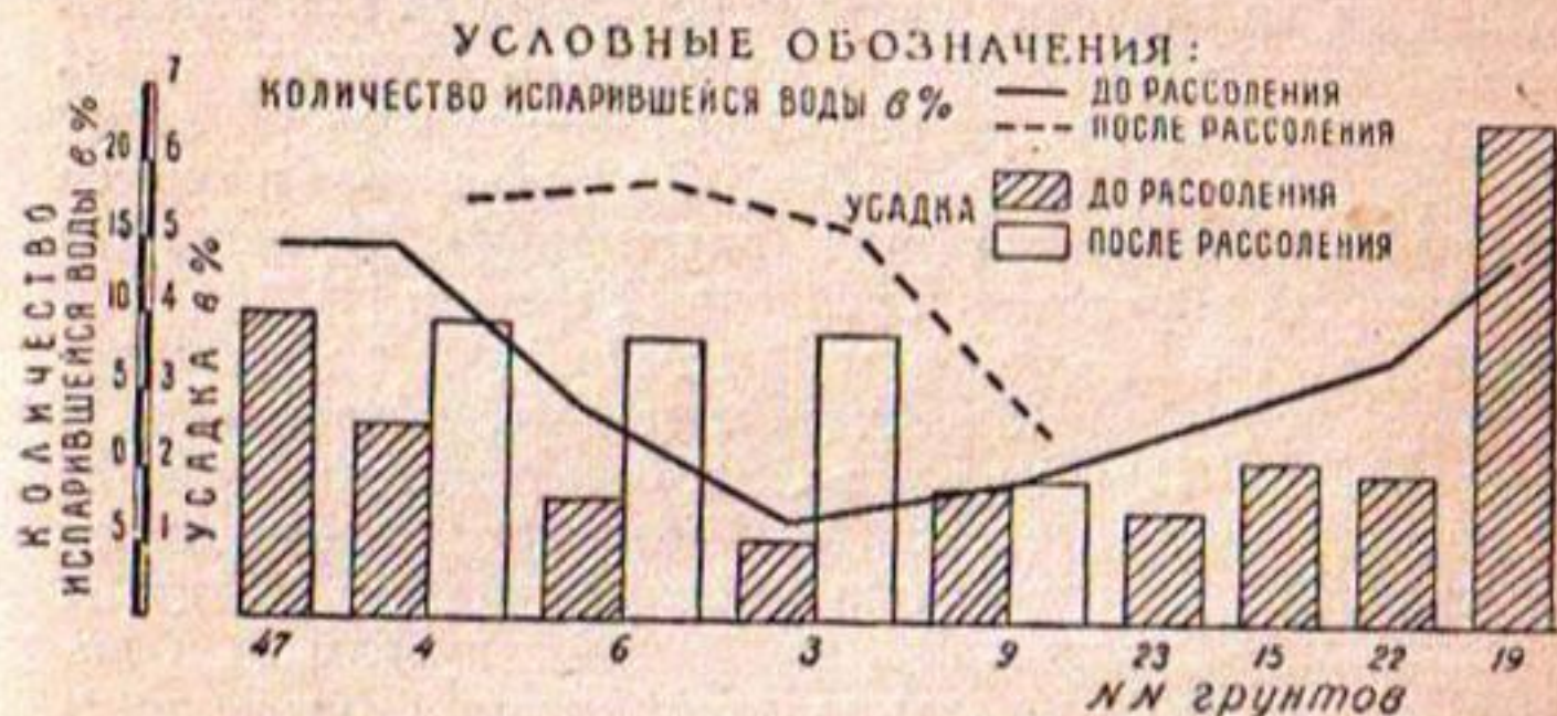
Р и с. 11. Линейная усадка (при исходной влажности, равной верхнему пределу пластичности).
