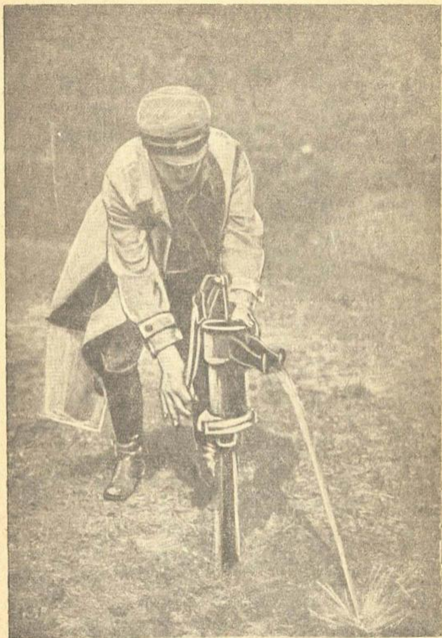
Рис. 2. Общий вид работы ручного насоса „Нортон“.
