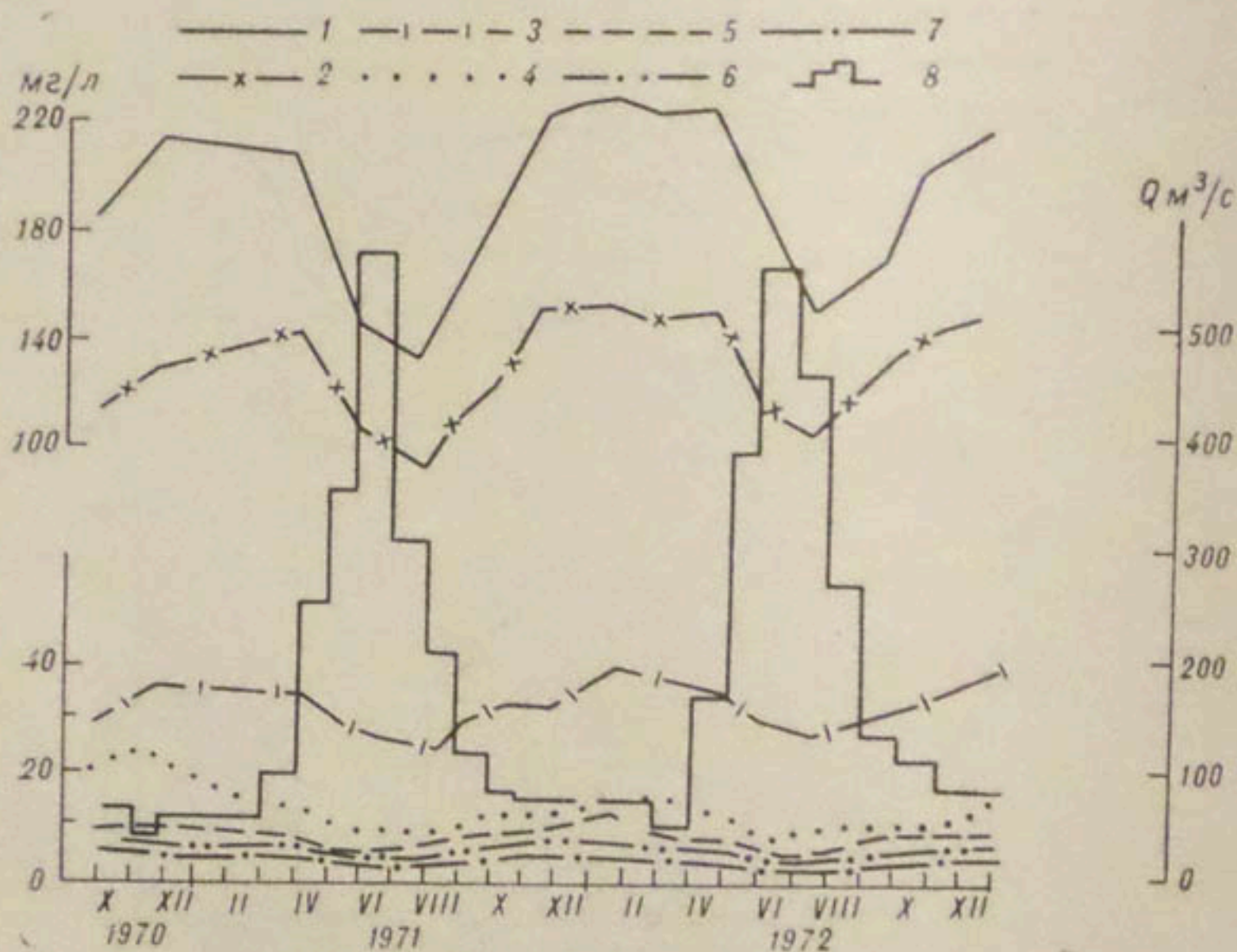
Рис. 5. Изменение минерализации, главных ионов и расхода воды в нижнем бьефе водохранилища.
