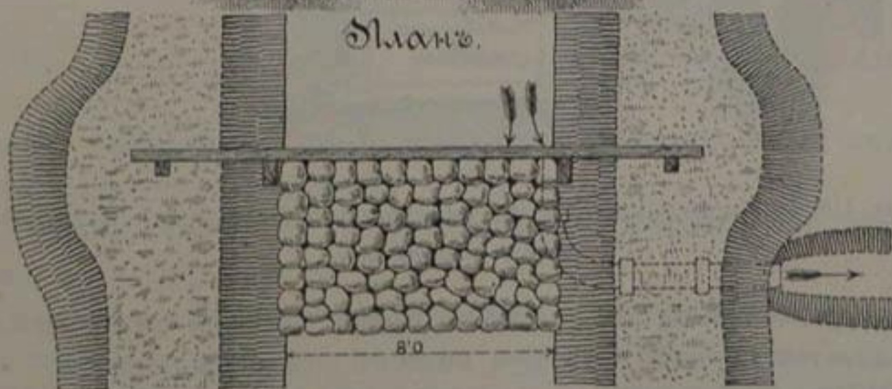
Черт. 115, 116 и 117. — Деревянная плотина съ водобойнымъ поломъ изъ каменныхъ глыбъ.
