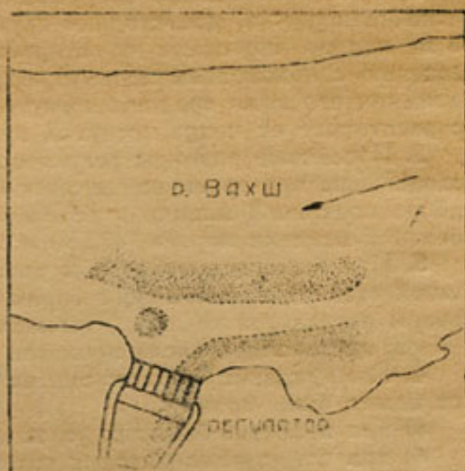
Рис. 12. Схема отложений донных наносов при отсутствии бара ниже поперечника № 4. Положение регулятора 1-ое Q реки = 220 \text{ м}^3/\text{сек.} , q канала = 100 \text{ м}^3/\text{сек.}
