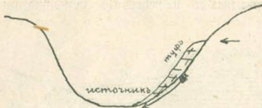
Черт. 44. Источникъ воды, содержащей углекислую известь и соли закиси желѣза, выходитъ у нижняго края туфовыхъ отложеній, образовавшихся отъ осаждевія выдѣляющихся изъ воды химическихъ соединений.
