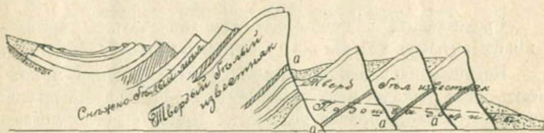
Черт. 6. Сложный сбросъ. Свита пластовъ разбита на части нѣсколькими сбросами. По выходамъ породъ (обнаженіямъ) возможно составить неправильное представленіе о характерѣ напластованій: повторяющаяся четыре раза одна и та же порода а можетъ быть ошибочно принята за различныя послѣдовательныя напластованія, лежащія другъ на другѣ на значительномъ протяженіи.
