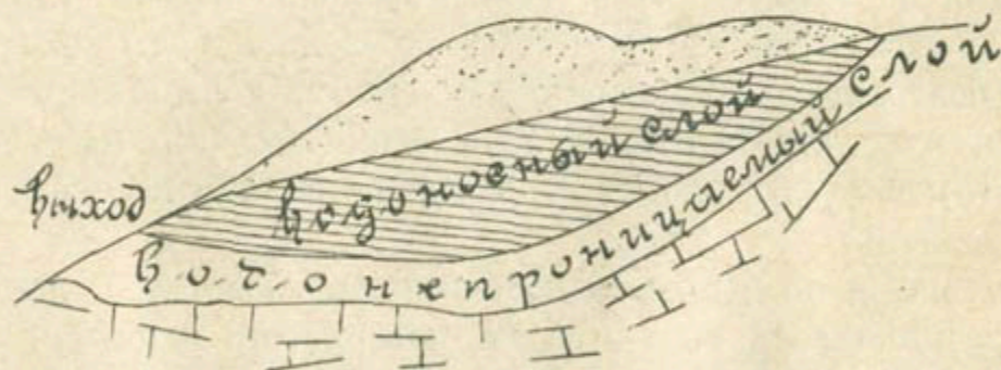
Черт. 25. Выходъ нисходящаго источника по уклону водонепроницаемаго слоя.
