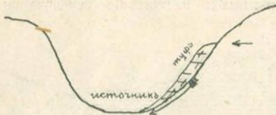
Черт. 44. Источникъ воды, содержащей углекислую известь и соли закиси желѣза, выходитъ у нижняго края туфовыхъ отложеній, образовавшихся отъ осажденія выдѣляющихся изъ воды химическихъ соединений.
