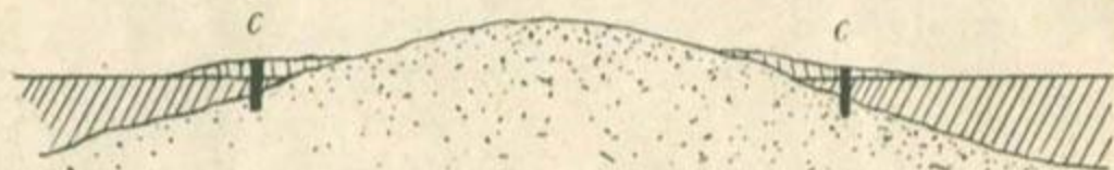
Черт. 19. Осложненіе бурового изслѣдованія, благодаря осыпямъ и вѣтровымъ отложеніямъ. У подножья песчанаго холма возможно ошибочное заключеніе о существованіи свиты трехъ пластовъ, вмѣсто дѣйствительно существующихъ двухъ.
