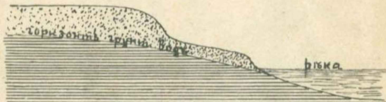
Черт. 47. Разрѣзъ водоносной породы подъ склономъ съ террасами въ случаѣ маловоднаго подземнаго теченія, когда не происходитъ касанія горизонта грунтовыхъ водъ съ поверхностью земли, и вода безъ образованія источниковъ на террасахъ прямо вливается въ рѣку.
