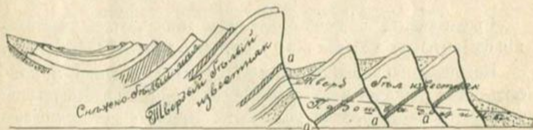
Черт. 6. Сложный сбросъ. Свита пластовъ разбита на части нѣсколькими сбросами. По выходамъ породъ (обнаженіямъ) возможно составить неправильное представленіе о характерѣ напластованій: повторяющаяся четыре раза одна и та же порода a можетъ быть ошибочно принята за различныя послѣдовательныя напластованія, лежація другъ на другъ на значительномъ протяженіи.
