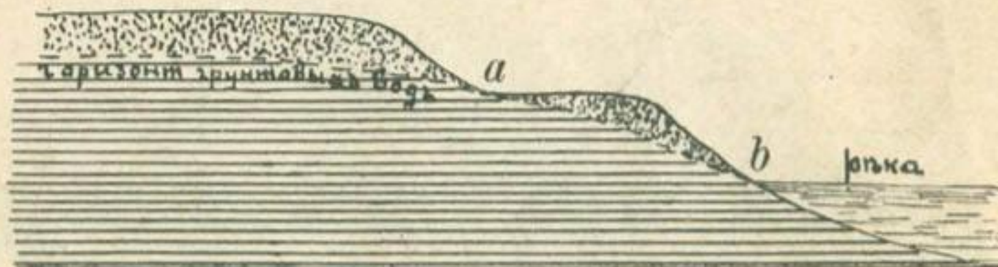
Черт. 46. Источникъ на подошвѣ склона съ террасами въ мѣстѣ касанія a —горизонта грунтовыхъ водъ съ поверхностью земли, b —мѣсто касанія на берегу рѣки.
