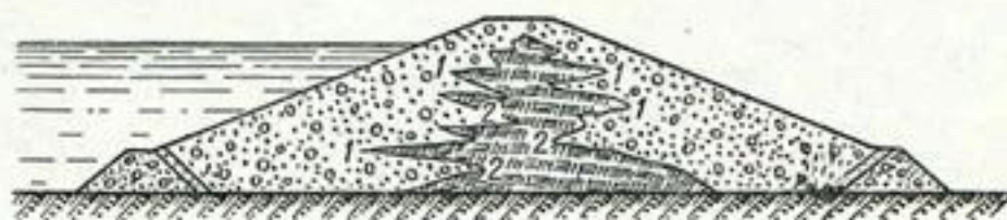
Рис. 13—12. Намывное ядро плотины: 1 — языки; 2 — карманы.
