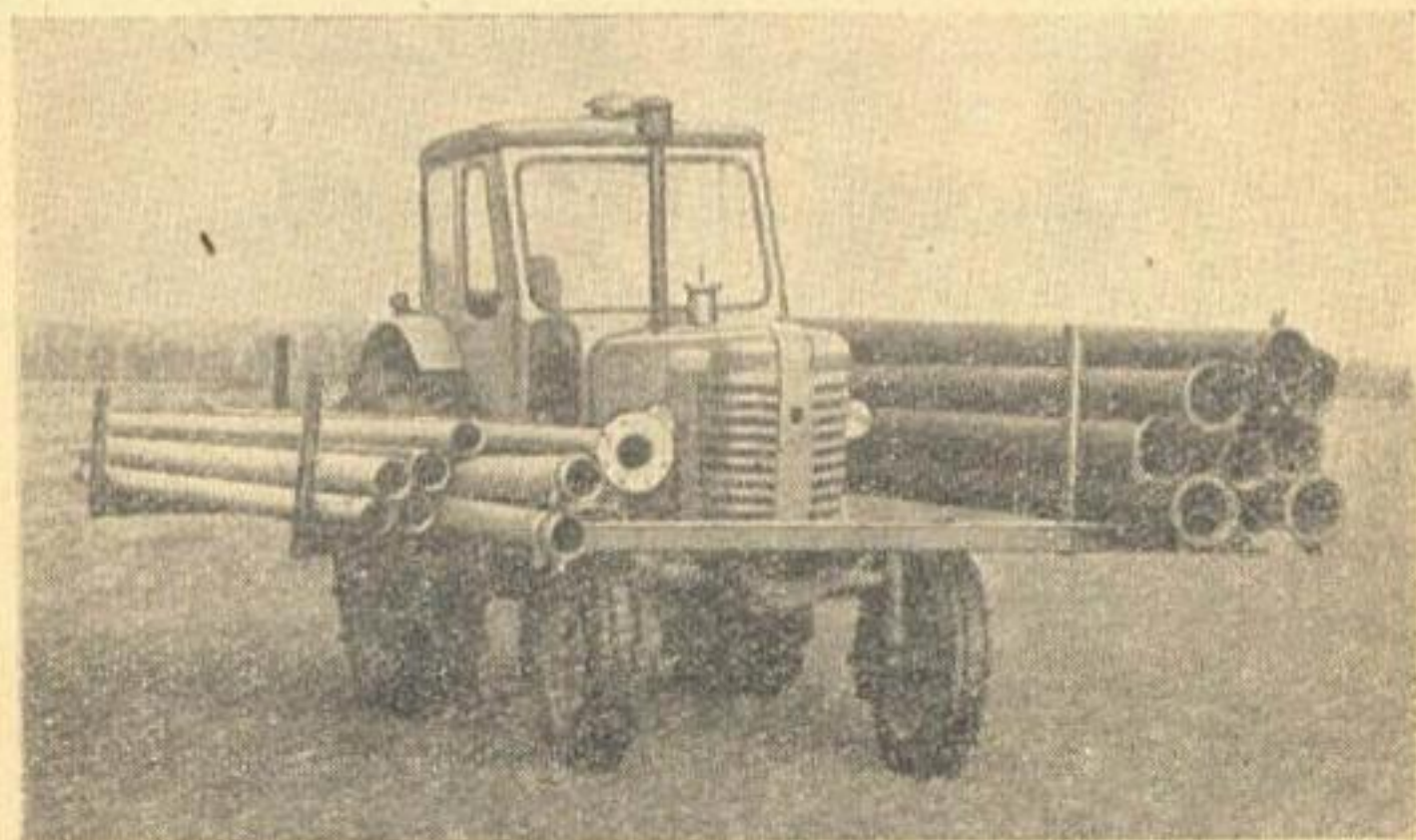
Рис. 8. Пропашной трактор, оборудованный для перевозки труб.
