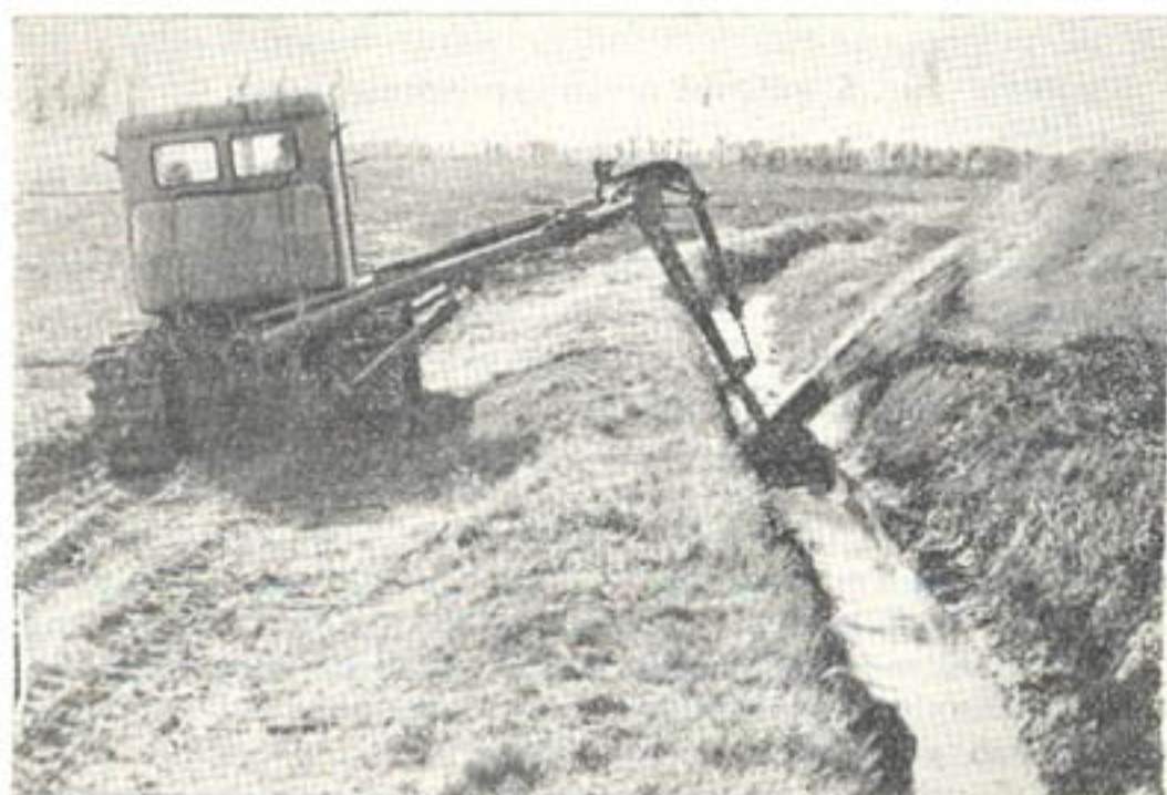
Рис. 4. Каналоочиститель Д-342А с роторным рабочим органом.
