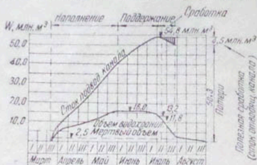
Рис. 5. График работы водохранилища в 1962 г.
