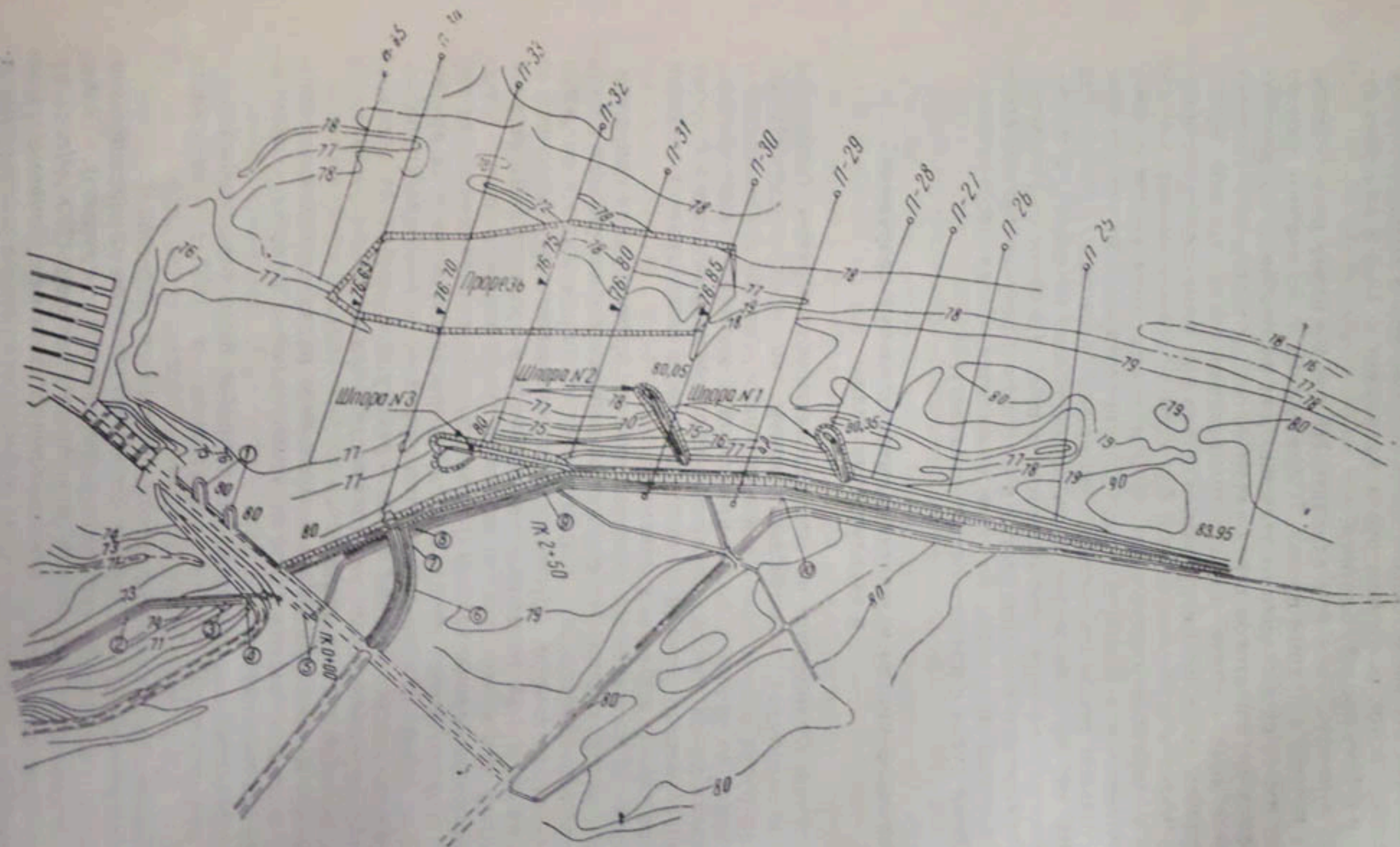
Рис. 21. План гидроузла (показаны выполненные регулировочные работы в натуре):
