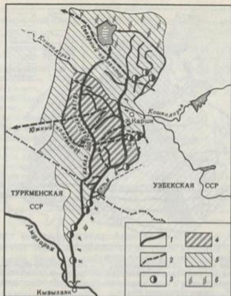
Рис. 17. Орошение Каршинской степи 1 — оросительные каналы (магистральные); 2 — коллекторно-сбросные (главные) каналы; 3 — насосные станции; 4 — земли первоочередного орошения; 5 — зона перспективного орошения
