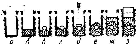
Рис. 78. Схема технологического процесса, выполняемого дренукладчиком Д-251
