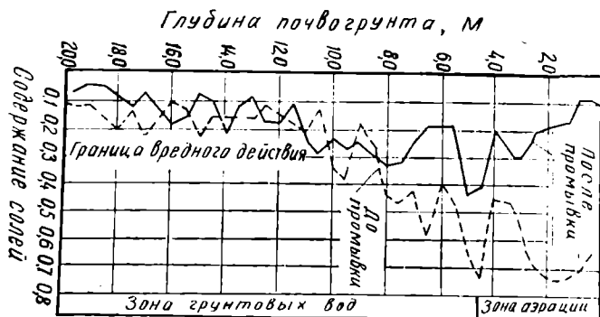
Рис. 92. Запас вредных солей в почвогрунте до и после промывки нормой 64 тыс. м 3 /га (ВНИИГиМ, 1963)
