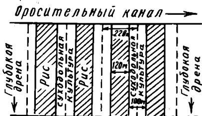
Рис. 91. Схема расположения посевов при двухтактной форсированной промывке
