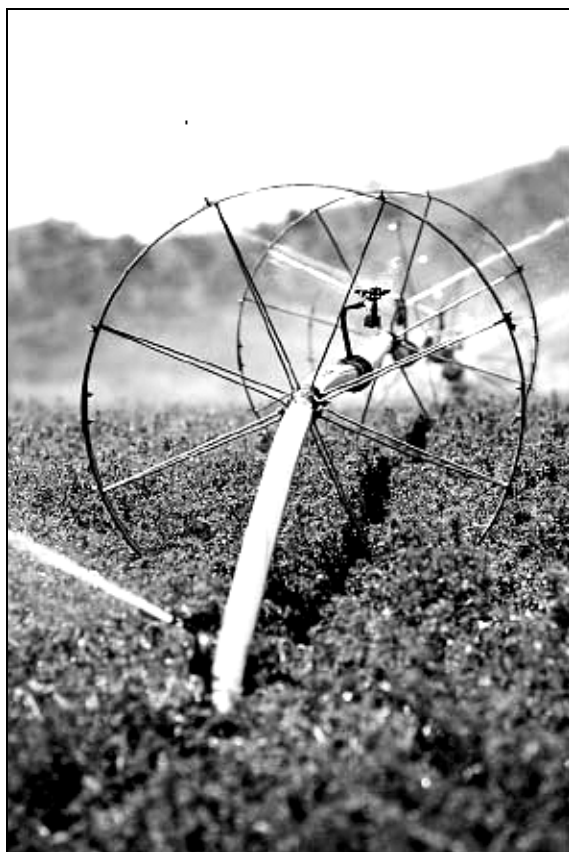
Рис 7.5. Дождеватель колесный широкозахватный ДКШ-64 “Волжанка”.
