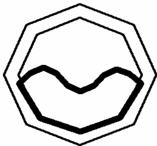
Рис 4.4.1. Прокладка жесткой сплюсненной трубы внутри старой
