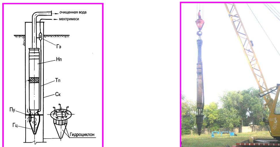
Рис.1. Конструктивная схема и опытный образец насоса типа ЭЦВ снабженного с вакуум - гидроциклоном
